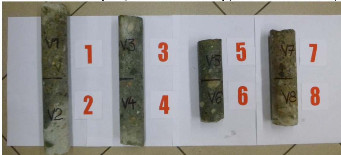
Foto 3.1: Dokumentace vývrtů pro destruktivní zkoušky pevnosti v tlaku betonu opěr
